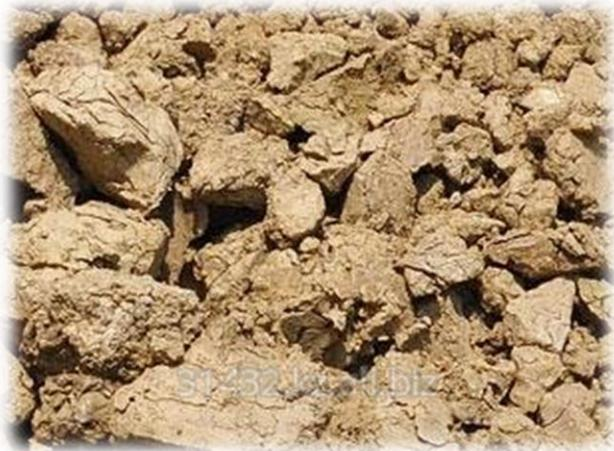
Природные залегающие бентониты обычно имеют **pH 6—9,5** (для 5 % водной суспензии после её отстаивания в течение 1 часа) и содержат менее 2 %  $\text{Na}_2\text{CO}_3$ ; общее содержание взаимозаменяемых натрия и кальция не превышает 80 мг/100 г.
