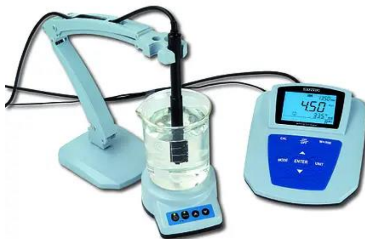
Рисунок 4 – Оксиметр Ulab MP 516 с магнитной мешалкой
