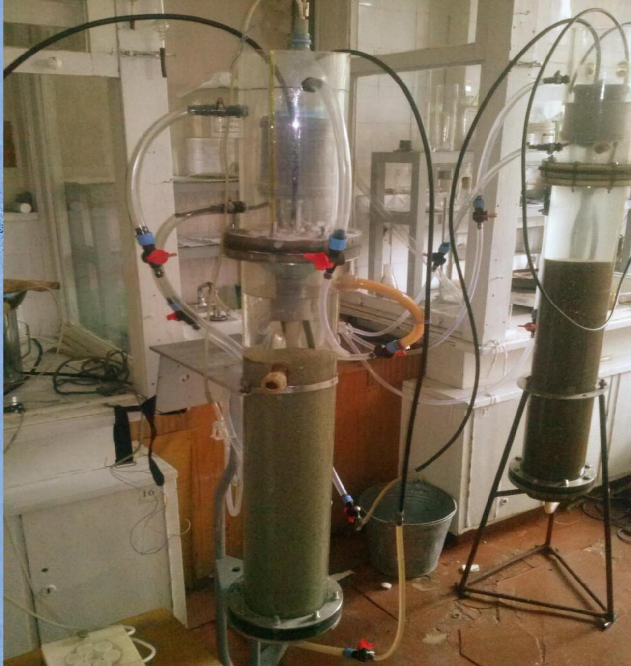
При использовании данной разработки возможно увеличение срока службы ионообменной смолы в 2-3 раза, уменьшение расхода регенерирующих материалов в несколько раз, обезвреживание вредных стоков и сопутствующее извлечение из них ценных компонентов, упрощение технологической схемы при получении **глубокообесоленной воды.**
