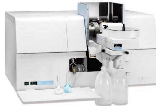
Анализ воды на содержание тяжелых металлов осуществляется с помощью атомно-абсорбционного спектрометра Aanalyst 800 (Perkin Elmer). Метод позволяет определять сейчас около 70 элементов. В основном это металлы, но возможно применение метода и для некоторых неметаллов: As, B, I, P, Se, Si и Te. Причем, для большинства определяемых элементов (около 40) возможно достижение относительно низких пределов обнаружения: в
